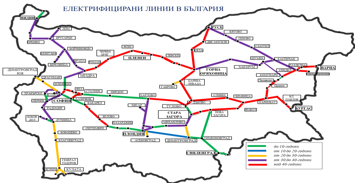
Графика № 12. Състояние на енергетичните съоръжения по периоди на внедряване
