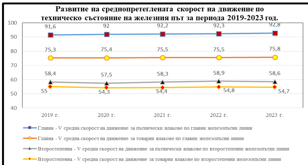
Графика № 10. Развитие на средна скорост на движение по техническо състояние на железопътната инфраструктура за периода 2019-2023 г.
